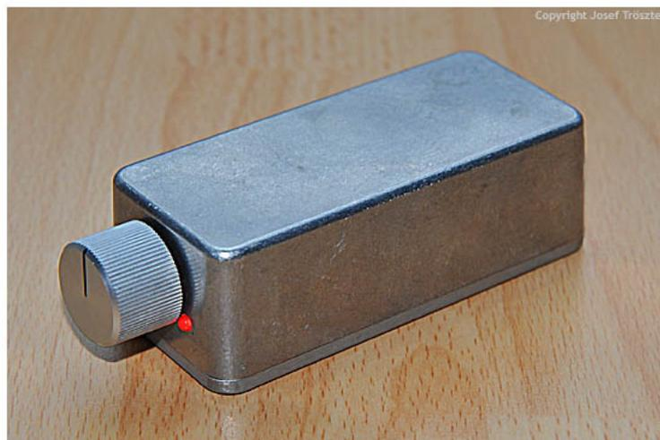
LM386-Kopfhörerverstärker für Batteriebetrieb in einem Hammond 1590A Gehäuse
