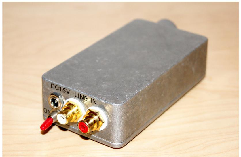
*Die Ähnlichkeit mit dem LM386-Kopfhörerverstärker ist nicht zu leugnen und durchaus gewollt. Auch der TC-70 wäre für lange Outdooreinsätze gut geeignet, ist aber für den Betrieb vom Stromnetz ausgelegt. Ein Hammond 1590B Gehäuse ist ein adäquater Schutz der Elektronik gegen mechanische und elektromagnetische Einwirkungen von außen. Vergoldete Chinch-Buchsen ermöglichen den Anschluß von Audiogeräten mit Line-Pegel.*
