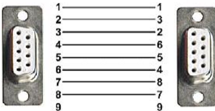
serielle Nullmodem-Verbindung mit 8 Leitungen und "Hardware-Handshaking"
