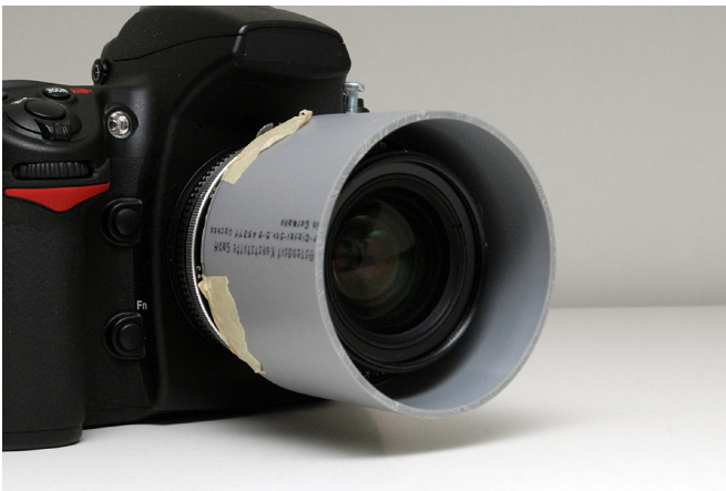
Die HK-12-DIY wurde im Rohzustand für verschiedene Tests provisorisch an das Zoom-Nikkor 28-50mm/3,5 montiert. Bei dieser Gelegenheit habe ich auch herausgefunden, dass man mit zwei Schrauben eine wesentlich bessere Fixierung am Objektiv erreicht. Links ist die Gegenlichtblende bei kürzester und rechts bei längster Brennweite abgebildet.
