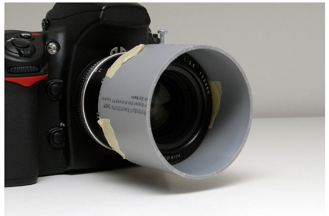
Die HK-12-DIY wurde im Rohzustand für verschiedene Tests provisorisch an das Zoom-Nikkor 28-50mm/3,5 montiert. Bei dieser Gelegenheit habe ich auch herausgefunden, dass man mit zwei Schrauben eine wesentlich bessere Fixierung am Objektiv erreicht. Links ist die Gegenlichtblende bei kürzester und rechts bei längster Brennweite abgebildet.
