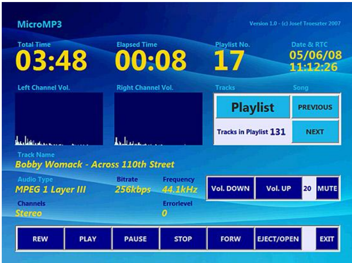
Der Audioplayer MicroMP3 ist für die Fingerbedienung ausgelegt und benötigt nur 700kB Systemressourcen
