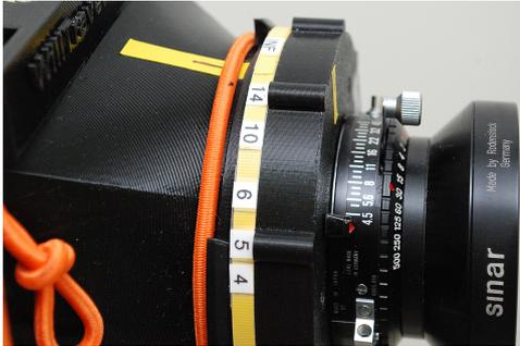
Meine DIY-Entfernungsskala besteht aus Klebeband und Zahlen aus einem Brother-Beschriftungssystem. Es sollte genau "kalibriert" werden und die Beschriftungen sollten wasserfest sein, sonst ist bereits nach den ersten feinen Regentropfen die Skala zerronnen.
