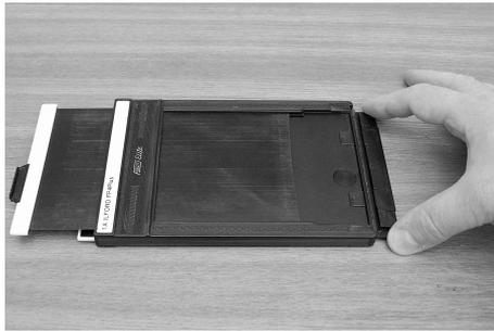
Jetzt die Hände waschen, denn Handschweiß und Schmutz erzeugen Abdrücke am Film. In der Dunkelkammer wird die Planfilmkassette so aufgelegt, dass die Schieber nach links zeigen. Dann wird der oben liegende Schieber etwa vier Zentimeter herausgezogen. Der untere Schieber gehört zur zweiten Seite und bleibt eingeschoben.
