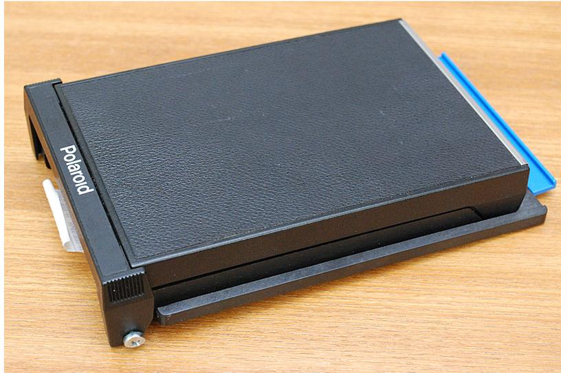
*Die Polaroid Kassette vom Typ 405 ist für 3,25"x4,25"-Filme ausgelegt und hat einen Anschluß für das Internationale Rückteil. Diese 405er-Kassette befindet sich in gutem Zustand, lediglich einer der Zapfen am Verriegelungsbügel war gebrochen und für mich zu laienhaft instand gesetzt. Ich habe ein 4mm-Gewinde in die Kassette geschnitten und den Zapfen mit einer Linsenkopfschraube M4x10mm ersetzt. Das ist eine stabile Lösung.*
