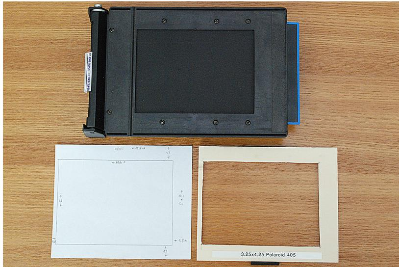
*Ich habe mehrere Versuche benötigt, bis ich eine akzeptable Formatmaske gebaut habe. Die Versionen aus Papier waren kurzlebig und ständig "vom Winde verweht", die Variante aus Sperrholz zu schwer und klobig bis ich schließlich bei Graupappe als Material gelandet bin. Mit schwarzem Klebeband überzogen ist das bisher die langlebigste Formatmaske. Der Bildausschnitt ist zu etwa 95% genau, was in diesem Fall völlig ausreichend ist.*
