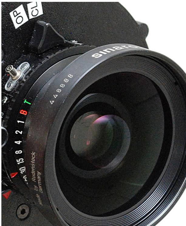
Das optische System dieses Objektivs besteht aus acht Linsen in vier Gruppen. Es ist in zusammengesetztem (eingebautem) Zustand eine Einheit bestehend aus optischem System, Blende und Verschluss. Belichtungszeiten und Blende werden direkt am Objektiv eingestellt und ein Blitzgerät kann mittels Synchronkabel angeschlossen werden. Der Zentralverschluss ist in allen Zeiten synchronisiert. Mit einem großen Schieber (OP/CL) kann der Verschluss für die Mattscheibenbetrachtung dauernd geöffnet werden.
