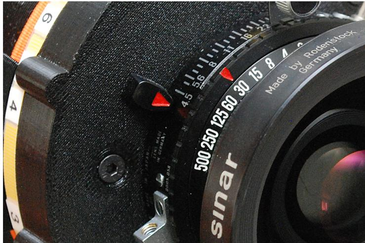
*Der Copal-0-Verschluss ist ein Standardprodukt und sehr zuverlässig. Alle Zeiten inklusive B und T sind für Blitzlicht synchronisiert und die Blendenwerte kann man von f4.5 bis f45 bequem in Drittelstufen einstellen. Ein Filtergewinde M67x0,75 nimmt handelsübliche Fotofilter auf.*
