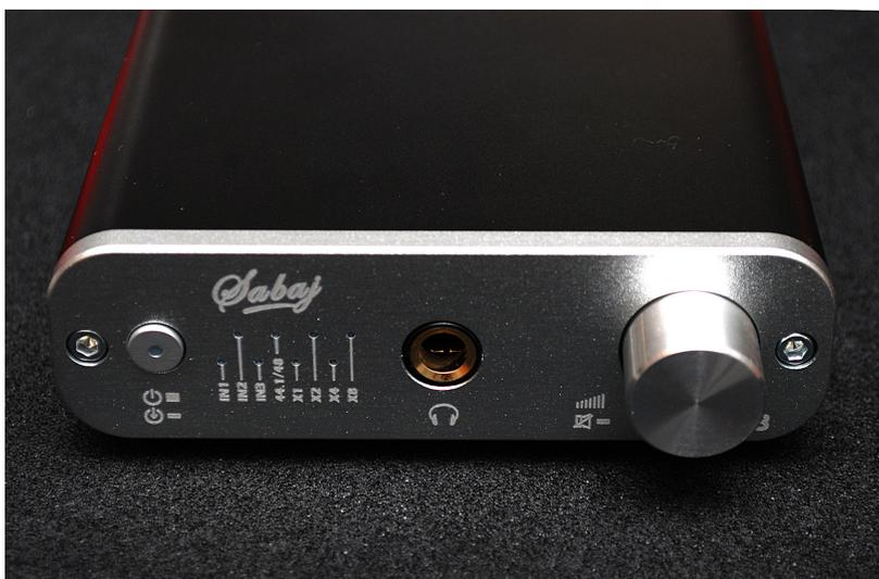
Die LED-Anzeigen informieren über den aktiven Eingang (USB/optisch/koaxial) sowie die Samplingrate. Ein kurzer Druck auf den kleinen Schalter wählt einen von drei Eingängen, ein langer Druck schaltet den Sabaj D3 ein bzw. wieder aus.
