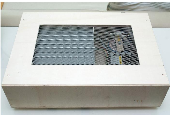
Der Gehäusedeckel wurde mit einem großflächigen Lüftungsgitter versehen um den Wärmehaushalt auf optimalem Niveau zu halten. Bis auf die fehlende Oberflächenbeschichtung ist das Gerät schon wohnzimmertauglich. In diesem Zustand steht das Gerät in meinem Büro und kommt dort gelegentlich zum Einsatz.
