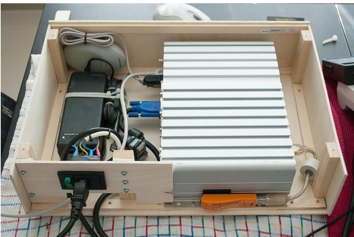
Den hiFace DAC hatte ich mit Klettverschluss an der Rückseite befestigt. Eine schlechte Lösung, die mittlerweile verbessert wurde. Das Netzwerkkabel war direkt an den Nexcom-PC angeschlossen und konnte bei geschlossenem Gehäuse nicht entfernt werden. Der Netzanschluss war nur bedingt berührungsgeschützt. Für den Testbetrieb war dieser Aufbau ausreichend.
