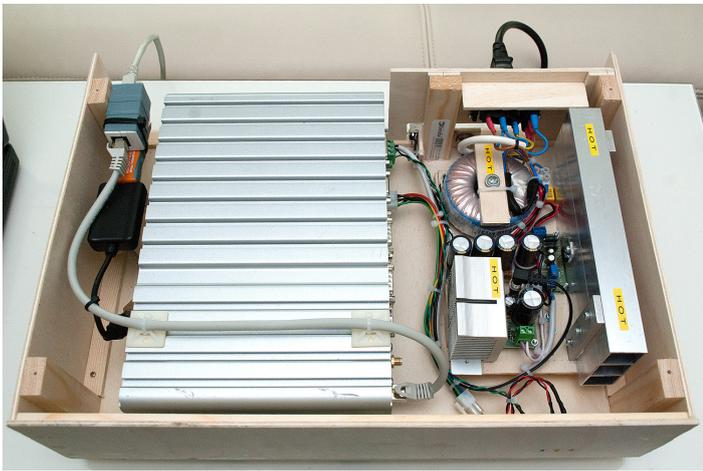
Der Audio-Player in seinem finalen Aufbau. Die Verkabelung ist fertiggestellt und notwendiger Berührungsschutz für Netzspannung ausgeführt.
