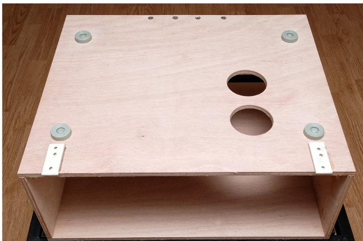
Im Bild links steht das Gehäuse am Kopf. Zwei Lüftungslöcher unterhalb des Computers sollen die Luftzirkulation verbessern. Sie gehören am Außengehäuse so angebracht, dass sie mit den Löchern in der Schublade genau übereinstimmen, sonst sind sie ziemlich sinnlos.
