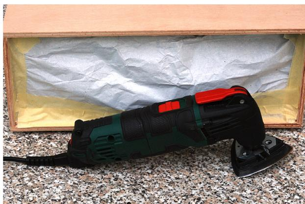
Schleifarbeiten bedeuten feinen Staub. Am besten man erledigt das im Freien oder nimmt einen Staubsauger als improvisierte Absauganlage, wenn man in einem Innenraum arbeiten muss. Man schleift so lange, bis es keine Mängel am Außengehäuse und der Frontplatte gibt. Zeit lassen und Geduld ist in dieser Phase sehr wichtig. Ist man mit dem Ergebnis zufrieden, wischt man das Gehäuse mit einem feuchten Tuch ab und entfernt den Schleifstaub. Dann trocknen lassen.
