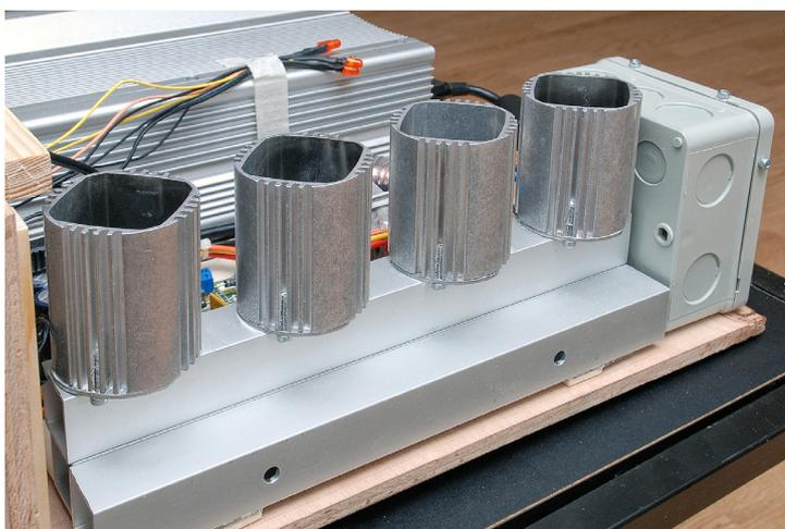
Der Netzteil-Kühlkörper besteht aus Aluminiumprofilen mit vier aufgesetzten Aluminiumbechern, die ich aus defekten und zum Recycling vorgesehenen HMI-Scheinwerfern entnommen habe. Die Aluminiumbecher haben eine große Oberfläche, sind relativ schwer und verbessern die Leistung des Kühlkörpers erheblich. Ein in der Entwurfsphase angedachtes Lüftungsgitter auf der Gehäuseoberseite kann dadurch entfallen, die offene Rückseite reicht zur Belüftung aus.
