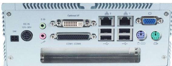
*Der Nexcom NIC3100 hat zwar nur einen Intel Celeron M Prozessor mit 1,6 GHz, dafür aber einen vollwertigen PCI-Steckplatz für eine USB-2.0-Schnittstellenkarte, welche nochmal helfen soll die Audioqualität zu verbessern. Dieses Gerät wurde im Juli 2018 um 50 Euro gekauft und funktioniert mit Daphile sehr zufriedenstellend.*
