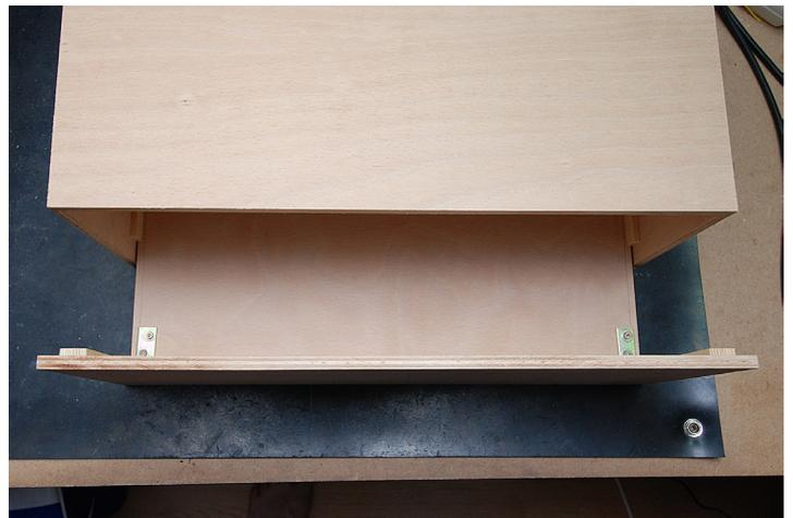
Das Bild rechts zeigt das Gehäuse von seiner Rückseite. Da eine Rückwand fehlt sieht man auf das eingelegte Schubladenelement: Platz ist jedenfalls genug und es passen auch größere Computer, wie z.B. ein Nexcom NICE oder NISE samt Netzteil und großem Kühlkörper problemlos hinein. Eventuell kann sogar ein kleiner Kopfhörerverstärker zusätzlich im Gehäuse untergebracht werden.
