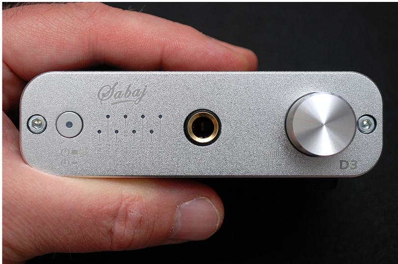
*Den Sabaj D3 DAC-AMP gibt es mit schwarzer und silberner Front. Das Gerät besitzt nur zwei Bedienelemente, eine Kopfhörerbuchse 6,35mm sowie einige LEDs zur Statusanzeige. Wie man sehen kann ist der D3 erstaunlich kompakt. Man kann ihn auch leicht mitnehmen und die Audioausgabe eines Notebook entscheidend verbessern.*
