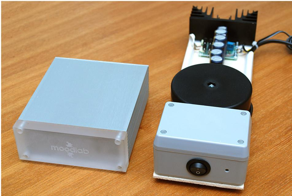
*Der Moodlab Dice und das neu konstruierte lineare Netzteil. Der DAC ist 11cm breit und 4,5cm hoch, das Netzteil orientiert sich im Groben an diesen Abmessungen, ist aber deutlich tiefer (etwa 30cm mit Kühlkörper).*
