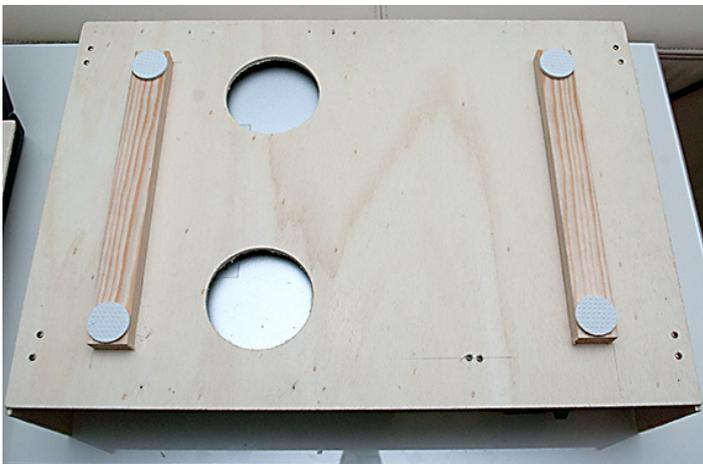
Auf der Unterseite befinden sich zwei Lüftungsöffnungen und zwei Holzleisten, die als Gerätefüße dienen. Auf ihnen wurden jeweils zwei Gummipads angeklebt, die als Schwingungsabsorber wirken und empfindliche Oberflächen gegen Kratzer schützen.
