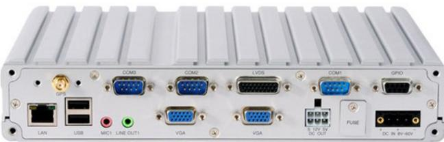
*Gut & günstig: Der ursprünglich für die ersten x86-Audio-Player von mir gewählte Nexcom VTC6200 ist ein Automotive-PC mit einem energiesparenden Intel Atom D510 Dual-Core Prozessor. Leistungsmässig für die gestellten Anforderungen als Audio-Player völlig ausreichend. Das stabile Aluminiumgehäuse ist gleichzeitig Kühlkörper und HF-Abschirmung.*
