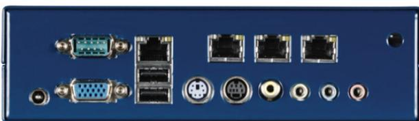
*Industrie-PCs haben oft ein Aluminium- oder Blechgehäuse. Das dient zur großflächigen Wärmeableitung vom Prozessor und ist zugleich auch ein guter HF-Schutz - ebenfalls Vorteile für den x86-Audio-Player.*
