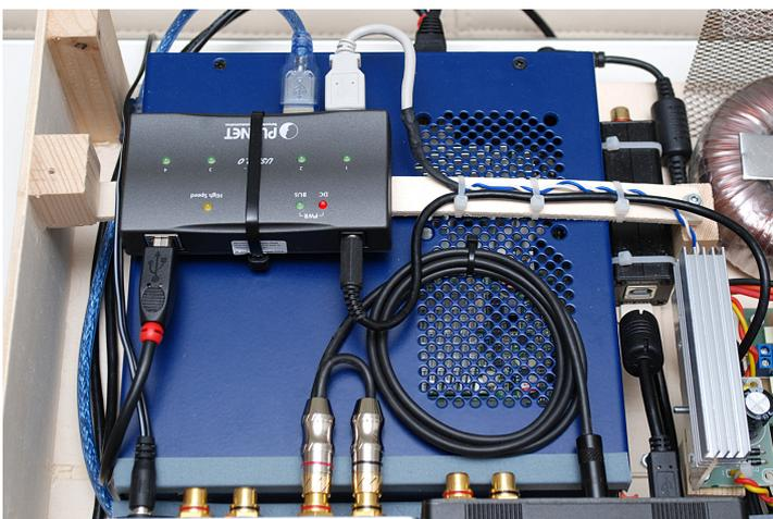
Der USB-Hub kann wahlweise aktiv mit einem externen Netzteil oder passiv über USB-Power vom PC betrieben werden. Eine rote LED zeigt Strom vom externen Netzteil an, eine grüne LED signalisiert USB-Bus-Power. Die Verkabelung habe ich so kurz als möglich gehalten und durchwegs qualitativ entsprechende Kabel verwendet.
