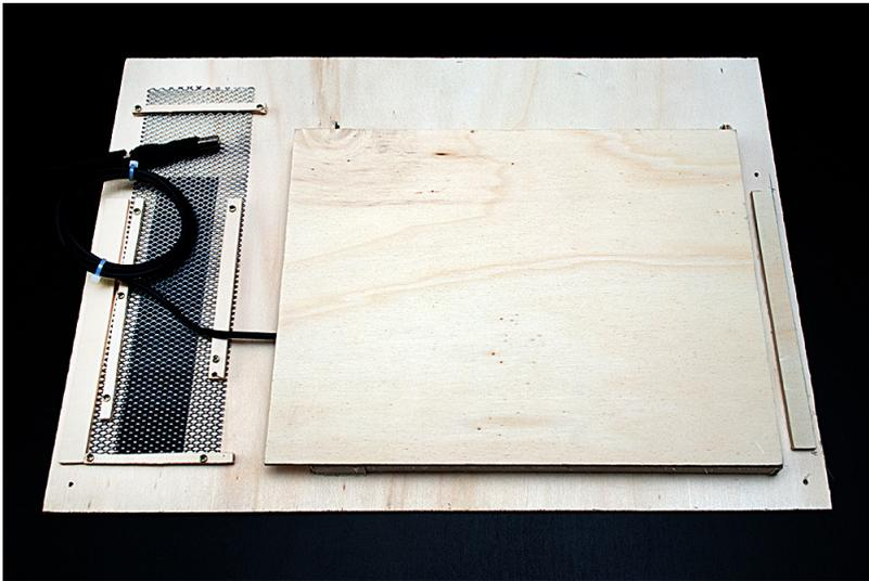
*Der Einschub für das Android-Tablet benötigt eine Höhe von etwa 1,5cm und nimmt einiges an Platz im Gehäuse ein. Dadurch verringert sich die Luftmenge und die Kühlung von PC und Netzteil wird anspruchsvoller und ist ohne Lüfter nicht machbar.*
