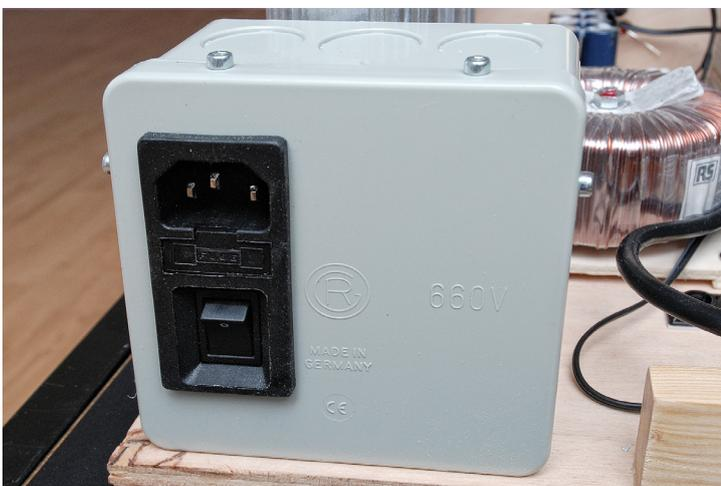
Bild links: Alle Teile die 230-Volt-Netzspannung führen sind in einem Plastikgehäuse untergebracht. Damit ist sichergestellt, dass man nicht unabsichtlich mit gefährlicher Netzspannung in Berührung kommt, wenn man am x86-Audio-Player herumschraubt. Der Netzschalter ist eine Kombieinheit bestehend aus Kaltgerätestecker, Netzfilter, Sicherung und Hauptschalter. Das Gehäuse ist übrigens eine Abzweigdose 100x100mm Artikelnummer 4062709 aus dem Hornbach Baumarkt.
