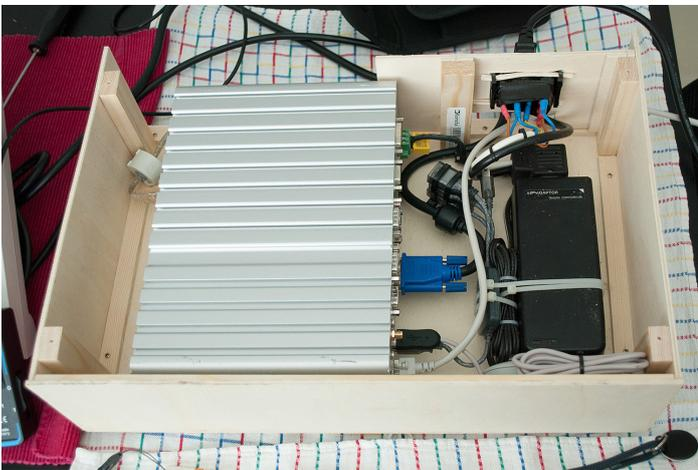
Das erste Gehäuse mit den ersten Einbauten. Der Netzanschluss ist noch sehr einfach und für den Testbetrieb hatte ich ein Schaltnetzteil mit 15 Volt und 2 Ampere Leistung eingebaut. Wie man sieht war auch ein VGA-Monitor und eine Maus angeschlossen. In dieser Konfiguration habe ich neben Winyl und Daphile auch Tests mit ein paar anderen Audio-Playern durchgeführt.
