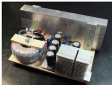
Ein lineares Netzteil eliminiert Störungen in der Stromversorgung und auf der 5-Volt-Schiene am USB-Bus. Sauberer Strom bedeutet weniger Störungen in der Stromversorgung und damit besseren Klang.
