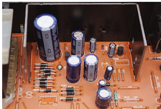
Bild oben: Das Netzteil mit originalen Elkos. Bild unten: erneuerte Elkos und neue Schottky-Dioden
