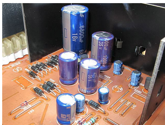
Bild oben: Das Netzteil mit originalen Elkos. Bild unten: erneuerte Elkos und neue Schottky-Dioden
