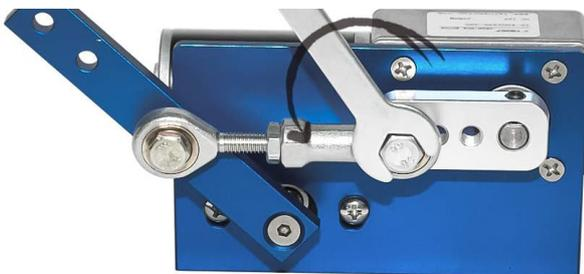
Als elektrische Versorgung reichen typisch 12 Volt und 2.000mA. Damit bewegt man auch schwere Entwicklungsdosen. 10 Volt und 2.500mA reduzieren die Drehzahl ohne großen Verlust an Drehmoment, wenn man eine etwas sanftere Bewegung wünscht.
