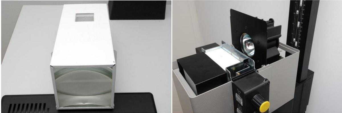
*Die Mischbox mit dem Doppelkondensator sitzt hinter dem Farbmischkopf. Die Abwärme der Lampe wird durch ein Wärmeschutzfilter und den Farbmischkopf sehr gut abgeblockt. Auch bei längeren Einstellarbeiten und langen Belichtungszeiten bleibt die Negativbühne schön kühl.*
