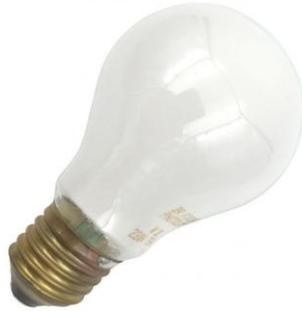
Als Leuchtmittel kommt im Durst M370BW eine Opallampe mit 75 Watt / 230 Volt mit E27-Gewinde und einer mittleren Brenndauer von 100 Stunden zum Einsatz. Die Lampe gibt es noch immer, weil es sich laut Definition um eine Speziallampe und keine Glühlampe handelt. Für Nachschub ist also gesorgt. Die Bezeichnung lautet *Opallampe OP75 230V 75W E27 PF-603E/51 Dr. Fischer* und man bekommt sie relativ preiswert bei Feldmann Speziallampen für ca. 7,00 Euro pro Stück:
