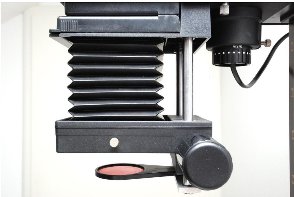
Der nächste Schritt bei der Aufstellung ist die Überprüfung ob Film- und Objektivenebene parallel zueinander stehen. Bei verschiedenen Abständen prüft man mit einem Meßschieber an den vier Ecken ob die Abstände gleich sind. Der M370 ist robust und es sollte hier üblicherweise keine Probleme geben.
