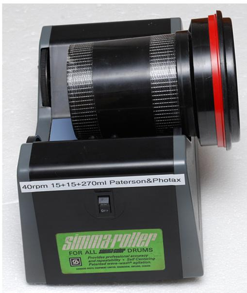
Für mich bietet die Rotationsentwicklung mehr Vor- als Nachteile. Mit einem einfachen elektrischen Roller erreicht man ohne großen Aufwand konstante Ergebnisse bei der Filmentwicklung. Dabei ist es egal ob man einen Durst Comot, die Ilford Roller Base, den händischen Jobo Roller 1590 oder einen alten Simma-Roller verwendet. Damit geht auch ein einzelner Film auf die Schnelle ohne großartige Vorbereitungen.
