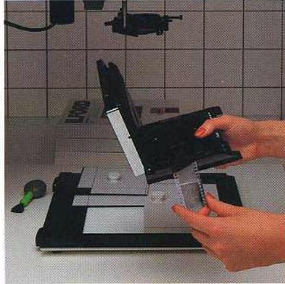
Jetzt suchen wir uns ein Negativ aus und achten darauf, es sauber und mit der Schichtseite nach unten in die Bühne des Vergrößerungsgerätes zu legen. Das normale Raumlicht wird aus-, die Dunkelkammerbeleuchtung eingeschaltet.
