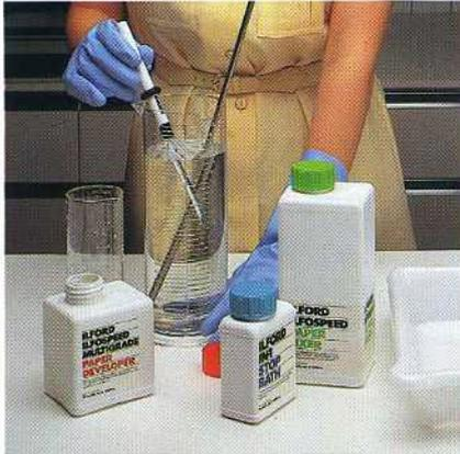
Wir setzen zuerst Entwickler, Unterbrecherbad und Fixierbad nach den beigefügten Anleitungen an. Die Lösungen sind ganz einfach mit Wasser zu verdünnen und sofort gebrauchsfertig.
