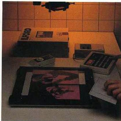
Bei Dunkelkammerlicht legen wir jetzt ein Blatt ILFOSPEED MULTIGRADE II-Papier mit der Schichtseite nach oben in den Vergrößerungsrahmen ein. Durch vier Probelichtungen, die nacheinander auf die vier Teilfelder dieses Blattes belichtet werden (z.B. 4, 8, 16 und 32 Sekunden), ermitteln wir die 'richtige' Belichtungszeit.
