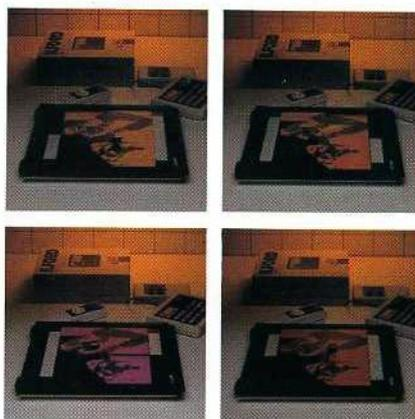
Mit der optimalen Belichtungszeit fertigen wir jetzt eine "Kontrastreihe" an. Filter von 0 bis  $1\frac{1}{2}$  machen das Bild 'weicher' – die Filter von  $2\frac{1}{2}$  bis 5 'härter'. Bei Proben mit den Filtern 4,  $4\frac{1}{2}$  und 5 wird die Belichtungszeit einfach verdoppelt.
