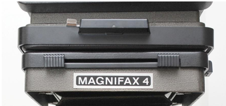
Das Negativ ist präzise scharfeingestellt, wenn der Schlitz durchgehend ohne Versatz verläuft.
