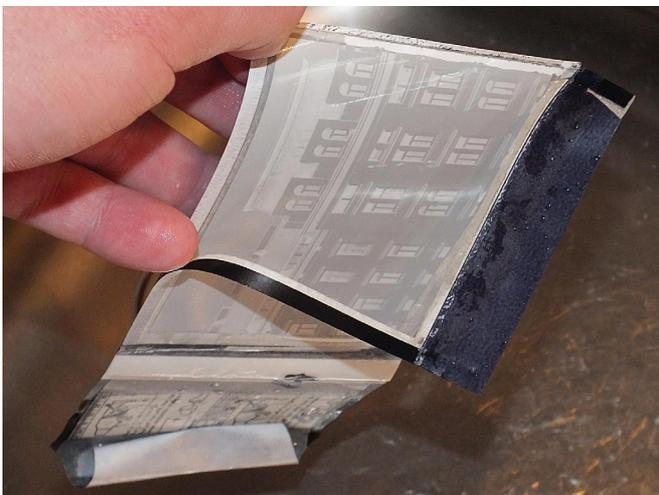
Vor der Trocknung sollte man alle nicht benötigten Papierteile vom Negativ trennen. Der Trockenvorgang wird dadurch verbessert, weil kein Wasser in den Papierteilen zurückbleibt und alle Feuchtigkeit vom Negativ abfließen kann.
