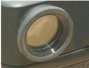
Verlorene Korrekturlinsen am Okular können leicht ersetzt werden. Es passen, wie bei vielen anderen Fujifilm/Fujica-Kameras, die Produkte von Nikon mit 19 Millimeter Durchmesser wie sie bei den FM- und FE-Serien Verwendung gefunden haben. Die Standard-Korrekturlinse hat die Artikelnummer FXA10066. Meine Erfahrung: Bereits bei geringster Fehlsichtigkeit sollte eine Korrekturlinse verwendet werden, weil sich damit das Sucherbild und das Messfeld stark verbessern lassen. Die
