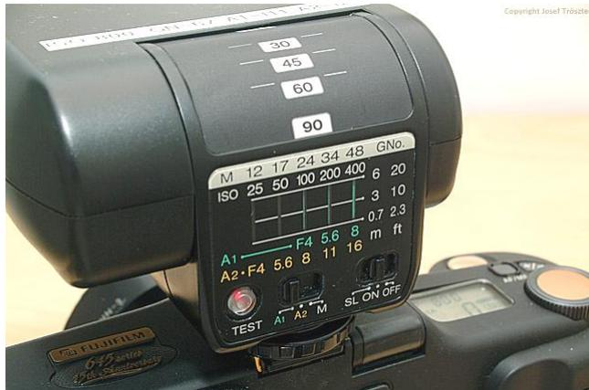
das originale Blitzgerät mit der Bezeichnung *Strobe GA*. Ein kurzer Test hat gezeigt, dass es gut mit der GSW690 III harmoniert. Mit einem Leuchtwinkel von 85° ist eine gleichmäßige Ausleuchtung des 65mm-Weitwinkelobjektivs (76° Bildwinkel) bis in die Randbereiche gegeben. Die automatische Steuerung der Lichtmenge klappt hervorragend und mit Leitzahl 24 bei ISO 100 steht auch genügend Leistung zur Verfügung. Mit einem Film der ISO-400-Klasse erreicht
