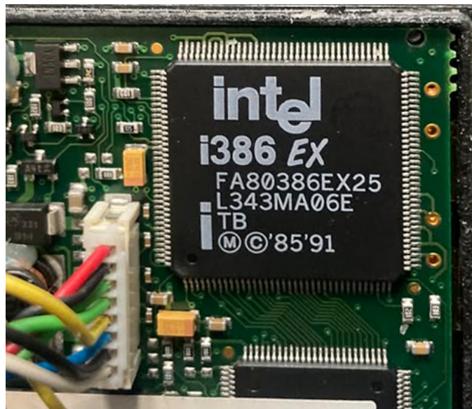
Der Intel i386EX steuert viele der frühen Garmin-Geräte. Er hat unter anderem den Vorteil, dass er als durchgetestet gilt, was bedeutet, dass es keine Betriebssituation gibt, wo es zu einem unvorhergesehenen Verhalten des Prozessors kommen wird. Für Steuerungsaufgaben wäre der i386EX auch heute noch eine gute Wahl. Im Bild ein Ausschnitt aus der Platine eines Garmin GPS (Foto: Internet, Hersteller unbekannt)
