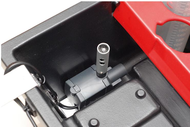
Das Bild links zeigt die komplette Umwälzung. Auf einem Aluminiumbügel ist eine Eheim CompactON 300 befestigt. Auf einem möglichst tiefen Niveau wird Wasser angesaugt und oben in Richtung Entwicklungsdose und Vorratsbehälter abgepumpt. Von der Pumpe habe ich alle Filter abgebaut, weil das Wasser in der Wanne der CPE2 sauber ist und keine Fremdkörper enthält. Die Pumpe arbeitet also mit ihrer maximalen Kapazität.
