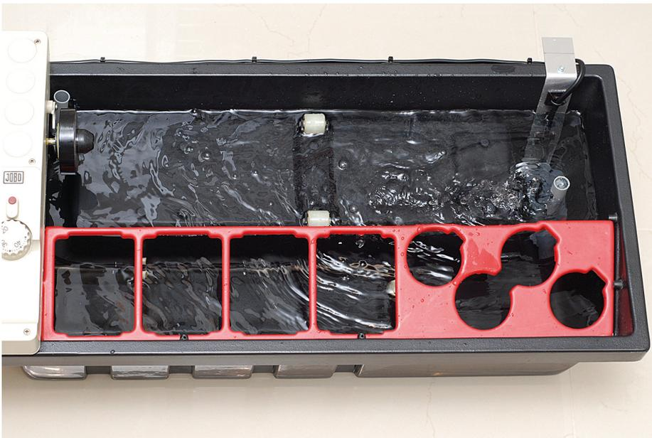
Die Umwälzung ist am bequemsten während der Aufheizphase. Hier ist die CPE2 ohne Flaschen und Becher abgebildet, ich wärme aber immer mit vollständig eingesetzten und vor allem gefüllten Behältern auf. Ist ja auch Sinn der Sache.
