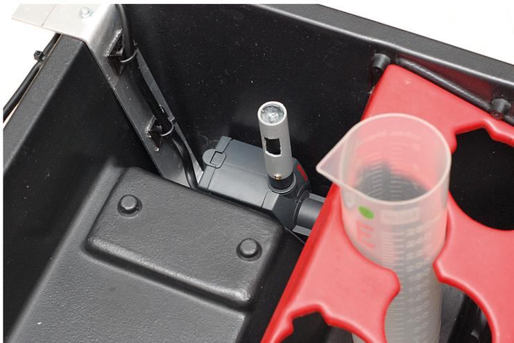
Das Ausströmen des Wassers erfolgt auf dem Niveau auf dem sich die Entwicklungsdose dreht. Zuerst habe ich mit einem Schlauchsystem experimentiert und später herausgefunden, dass ein einfaches Kunststoffröhrchen besser ist. Meine Röhrchen sind die Wickelkerne von Bonrollen aus Supermarkt-Kassendruckern. Ich habe mir in meinem Stamm-Supermarkt einige dieser Röhrchen geschnorrt und mich gefreut, dass sie für das Projekt so gut verwendbar sind.
