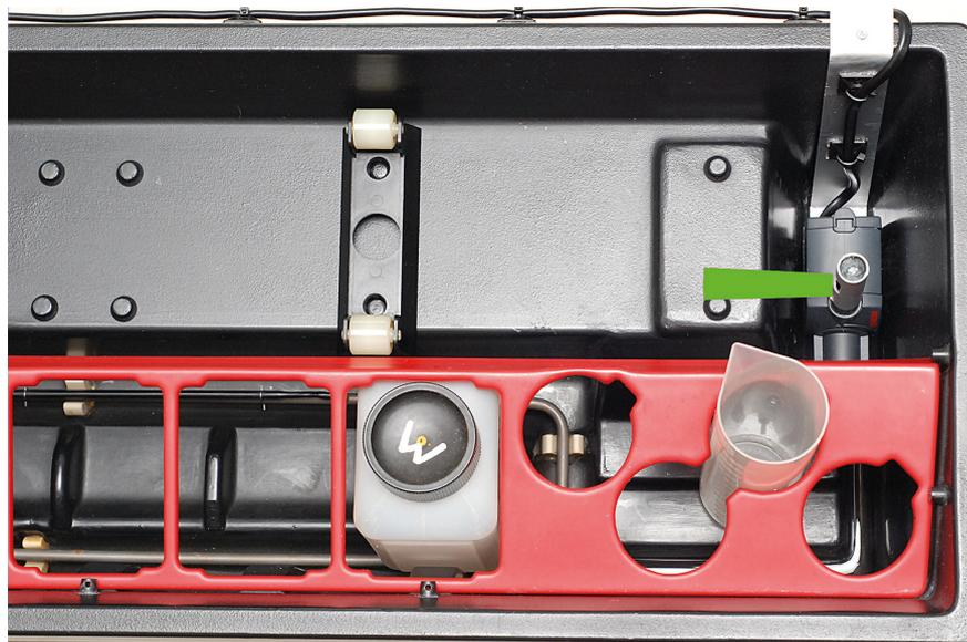
Der grüne Keil im Bild oben zeigt in etwa die Ausrichtung der Austrittsöffnung. Ich habe die Einstellung ziemlich exakt auf die Befestigung vom Rollenbock ausgerichtet. Die beste Wasserumwälzung erreiche ich, wenn sich die Strömung ziemlich exakt parallel zur roten Flaschenhalterung bewegt. Das Röhrchen kann ziemlich genau in horizontaler Richtung ausgerichtet werden, eine Spielerei, für die man aber ein wenig Geduld braucht.
