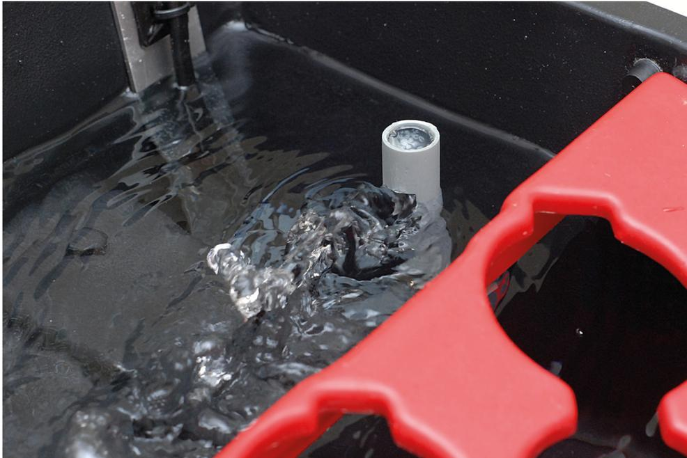
Hier ist die Pumpe bereits eingeschaltet. Bei diesem Röhrchen ist die Austrittsöffnung einen Hauch zu hoch angesetzt, was dazu führt, dass das Wasser während der Aufwärmphase ohne eingesetzte Entwicklungsdose gluckert und sprudelt. Mich stört das nicht und weil es sich um eine saubere Flüssigkeit handelt, ist auch keine Schaumbildung zu befürchten. Schöner wäre natürlich eine „gluckerfreie“ Umwälzung mit der die eingeschaltete Pumpe fast nicht mehr zu hören ist.
