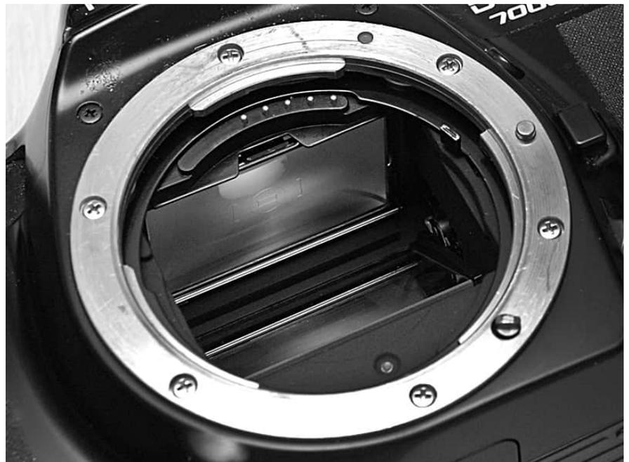
*Im Verlauf der Weiterentwicklung ist die Anzahl an Kontakten im Objektivbajonett gewachsen. Die Dynax 7000i hat nur fünf Stück, spätere Modelle bis zu acht Kontakte.*
