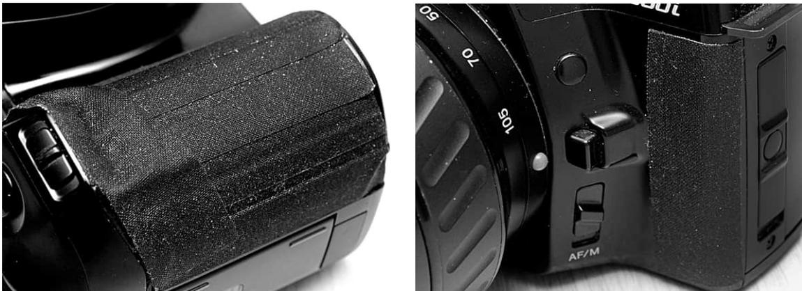
*Coroplast-Klebeband und vielleicht auch Panzerband hilft zuverlässig gegen bröckelnden Kunststoff.*
