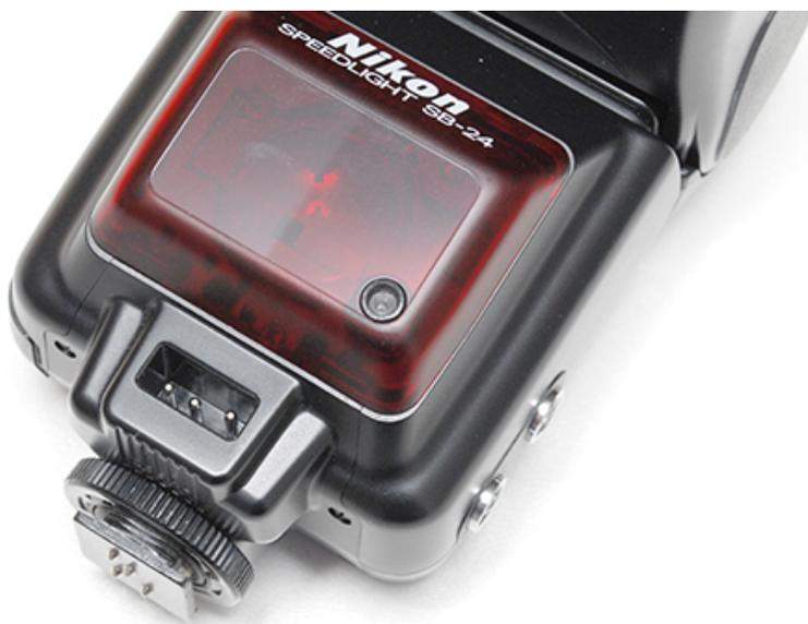
Den roten AF-Illuminator brauchen Ai- und AiS-Kameras nicht. Rechts unten ist in ihm der Lichtmengensensor eingelassen, der in der Betriebsart A (als Computerblitz) die Regelung der Blitzleistung übernimmt. Dieser Sensor ist für Kameras ohne TTL-Möglichkeit wichtig. Immerhin stehen sechs Computerblenden zur Auswahl mit denen man recht gut ohne TTL-Messung auskommt.
