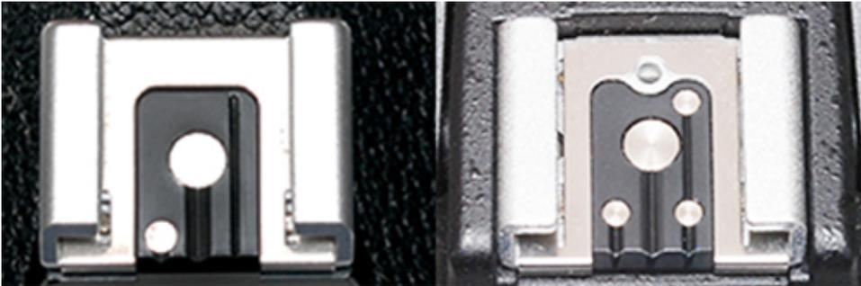
*Links der ISO-Blitzschuh mit einem zusätzlichen Kontakt für Blitzbereitschaft und gegebenenfalls der Einstellung der Blitzsynchronzeit an der Kamera. Rechts ein ISO-Blitzschuh mit drei Zusatzkontakten für TTL-Blitzmessung.*
