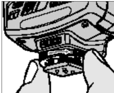
**5** Drehen Sie die Klemmschraube am Steckfuß des Geräts an ihren oberen Anschlag. Vermeiden Sie jede Gewaltanwendung!
