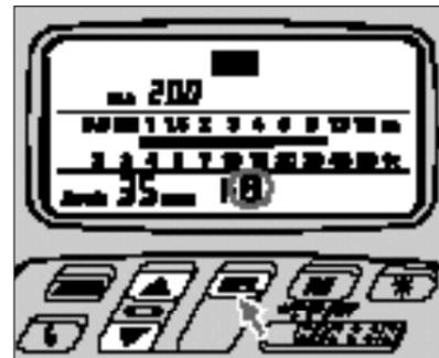
**3** Wenn die gewünschte Blendenzahl erscheint, drücken Sie zum Abschluß der Einstellung die Taste **[SEL]**. Die Anzeige hört daraufhin zu blinken auf. Die Blendenanzeige blinkt während der Einstellung und hört nach acht Sekunden zu blinken auf, sofern keine der Einstelltasten mehr gedrückt wird. Die letzte blinkende Zahl wird automatisch übernommen.
