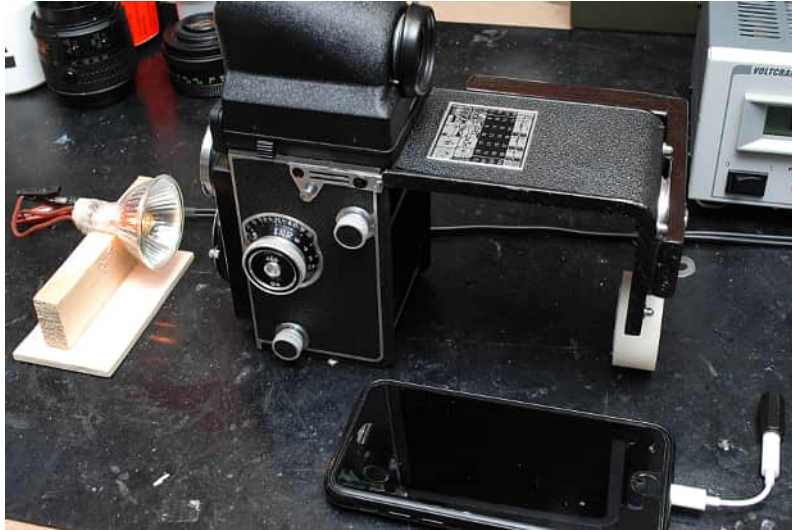
So sieht mein Messplatz bestehend aus 12V-Reflektorlampe gespeist von einem leistungsfähigen Labornetzgerät und dem PhotoPlug samt Smartphone aus.
