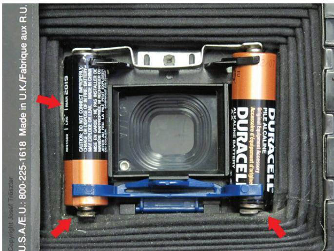
Ein vom Elektrolyt ausgelaufener Batterien gereinigter Balgen. Die roten Pfeile deuten auf Elektrolytreste hin, die nicht zu entfernen gewesen sind.
