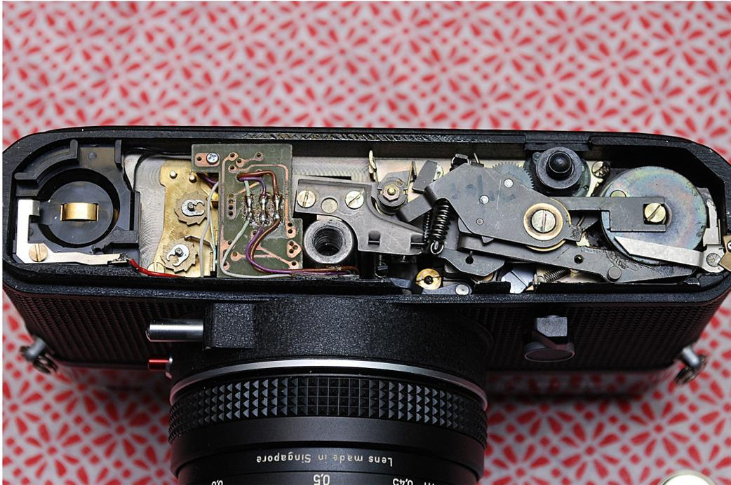
Die Zahnräder und Getriebe sind sicher kein High-End-Produkt. Da wurden Teile hastig aus einfachen Blechen ausgestanzt, man hat Material sparsam eingesetzt und sich auch beim Materialmix nicht an den damals gängigen Spitzen-SLRs orientiert.
