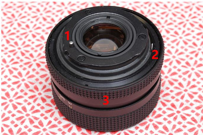
Die SL 35 M beherrscht Offenblendenmessung mit den zu ihr passenden QBM-Objektiven. Dieses Objektiv ist ein Typ III, den ich zur Verwendung mit der Kamera empfehle. Den Typ III erkennt man ganz leicht:
