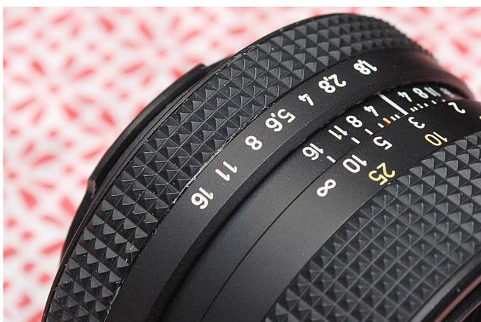
der Generation 2 bis 4 erkennt und Blendenring mit einer Gummierung versehen sind. Die erste Generation hat Einstellringe aus Metall mit Chrom-Zierrat und ist für Offenblendenmessung nicht geeignet.
