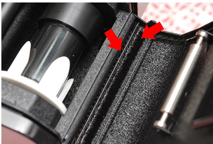
Lichtdichtungen sind bei dieser SL 35 M kein Thema. Im Bereich der Rückwand sind sie auch nach über vierzig Jahren noch in Ordnung.
