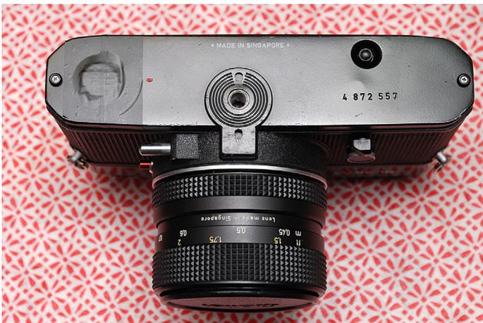
DIY-Batteriefach - Schritt 4: Bodendeckel drauf, die zwei Schrauben festziehen und fotografieren.
