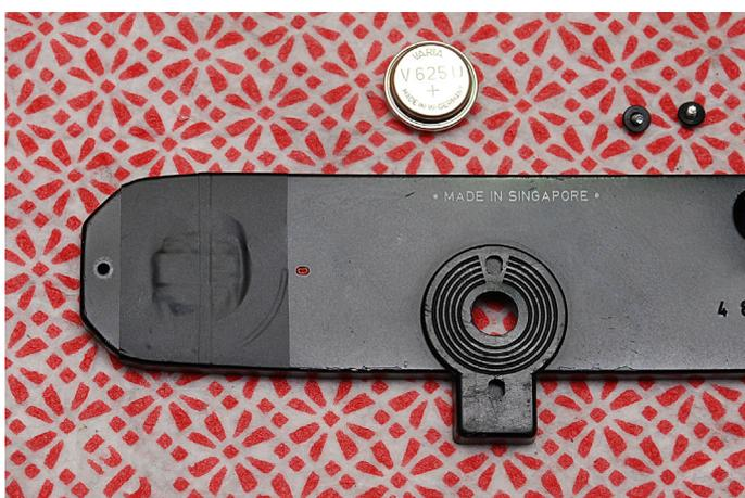
DIY-Batteriefach - Schritt 2: Mit schwarzem Isolierband die Aussenseite verschönern.
