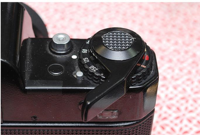
Der Filmtransport ist eine Schwachstelle der Rolleiflex SL 35 M und scheint deshalb so empfindlich zu sein, weil sich Schrauben lösen und sehr leicht Schmutz eindringen kann. Noch dazu dürfte Rollei in Singapur keine besonders rigide Qualitätskontrolle gehabt haben.
