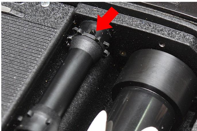
*Das Zahnrad am oberen Ende der Zahntrommel ist schmaler als üblich. Das schafft Platz für ein weiteres Zahnrad, welches das Bildzählwerk antreibt. Im Bild ist es zur besseren Erkennbarkeit verstellt, sonst stehen die Zähne synchron mit jenen auf der Zahntrommel.*
