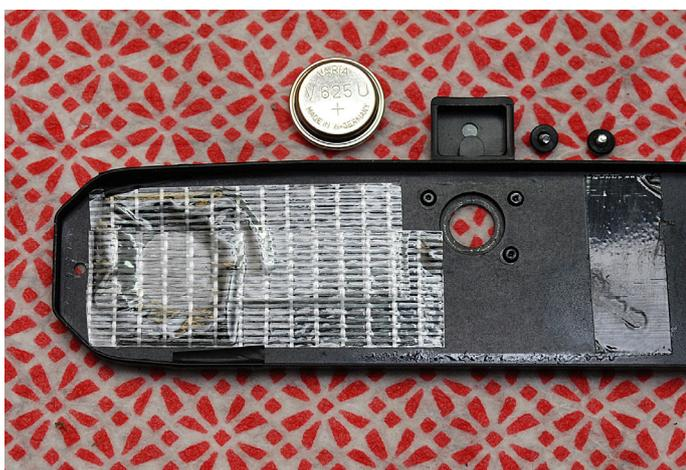
DIY-Batteriefach - Schritt 1: Mit Filamentband die Öffnung auf der Innenseite großflächig abkleben.
