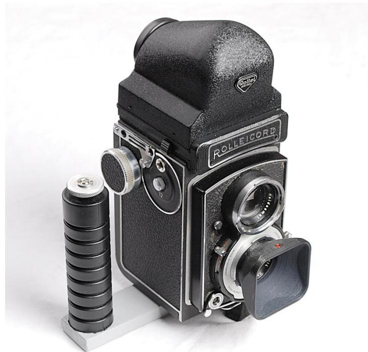
*So sieht die Rolleicord Vb mit dem DIY-Seitenhandgriff und der Gegenlichtblende aus dem 3D-Drucker aus. Mit dem Faltlichtschacht ist sie für eine 6x6-Kamera wirklich kompakt. Mit dem Rolleiflex-Prisma wird sie deutlich größer und schwerer. Der Handgriff ist dann fast ein Muss, sonst kann man die Rolleicord nicht gut halten.*
