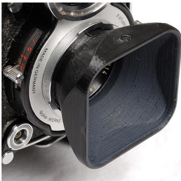
*Die Gegenlichtblende aus dem 3D-Drucker: Passt und funktioniert einwandfrei, auf den ersten Blick ist kein Unterschied zum Original feststellbar. Geht so eine Gegenlichtblende verloren oder kaputt, ist Ersatz nicht teuer und schnell verfügbar. Eine echte Empfehlung!*
