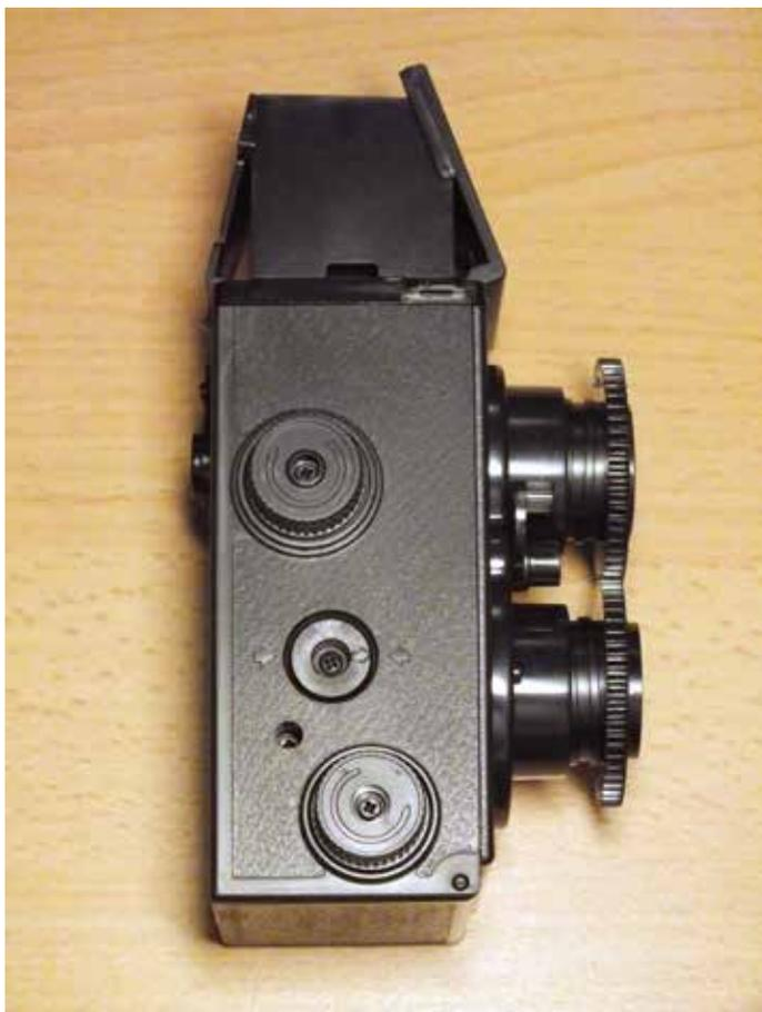
*Filmtransport und Filmrückspulung erfolgen über die beiden großen Räder und besitzen keine Sperren oder Sicherheitsfunktionen. In der Mitte ist der Anzeiger für den Filmtransport - eine halbe Umdrehung von Pfeil zu Pfeil entspricht einem transportierten Bild.*
