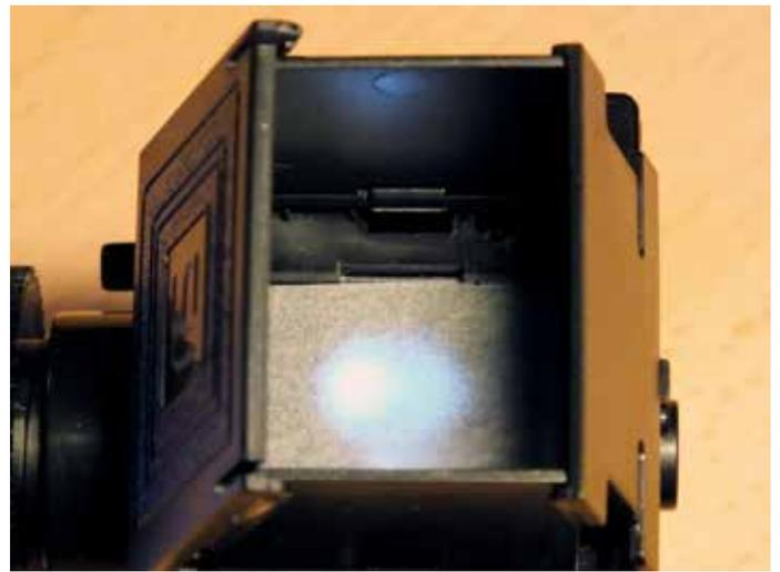
*Das obere Bild zeigt die Kamera mit der modifizierten Mattscheibe. Eine Lage Pergaminpapier aus einem Negativarchivstreifen macht die Somikon TLR erst zur vollwertigen Spiegelreflexkamera. Das Bild ist ausreichend hell und ermöglicht eine einigermaßen genaue Scharfeinstellung.*
