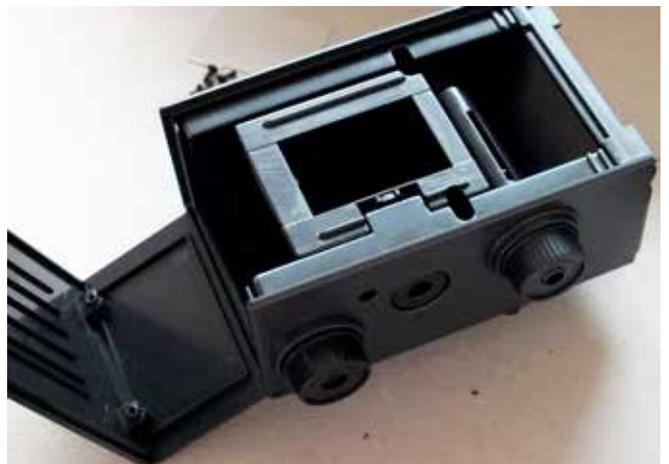
*Schritt 4: Filmtransport montieren und erster Gehäuse-Zusammenbau*
