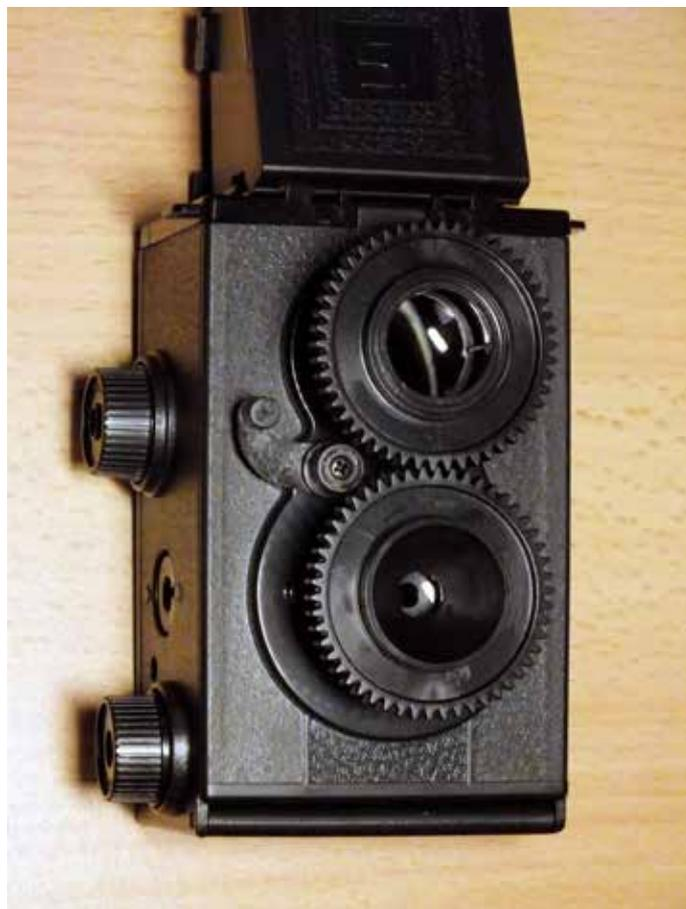
*Die Kopplung der Objektive bei der Scharfeinstellung erfolgt über Zahnräder an der Außenseite der Objektive. Im Bild ist die Blende auf f:11 eingestellt, meiner Meinung nach die einzige Art um mit der Somikon TLR einigermaßen scharfe Bilder zu bekommen.*
